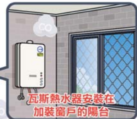
屋外式瓦斯熱水器 安裝在窗戶緊閉的陽台
