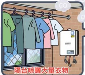
屋外式瓦斯熱水器 安裝在室內
